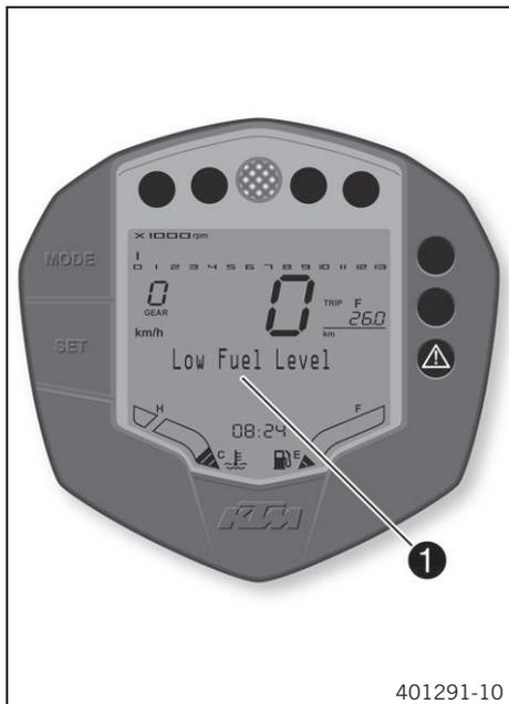
На информационном дисплее **1** отображаются различные предупреждающие сообщения. При включении общего предупреждающего индикатора
