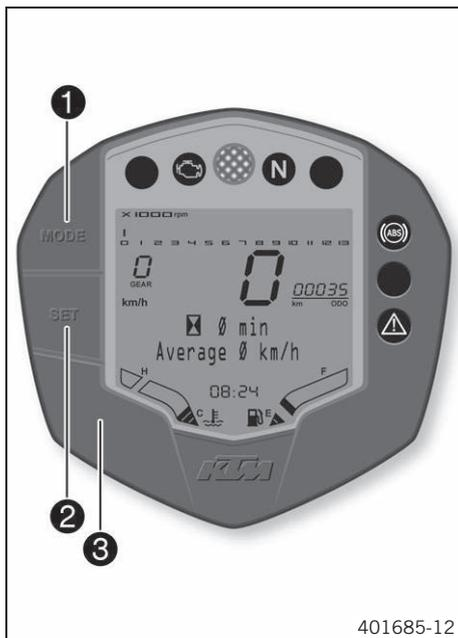
Можно изменить режим работы дисплея с помощью кнопки **MODE 1**.
