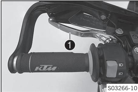
Рычаг сцепления **1** расположен слева на рукоятке руля.
